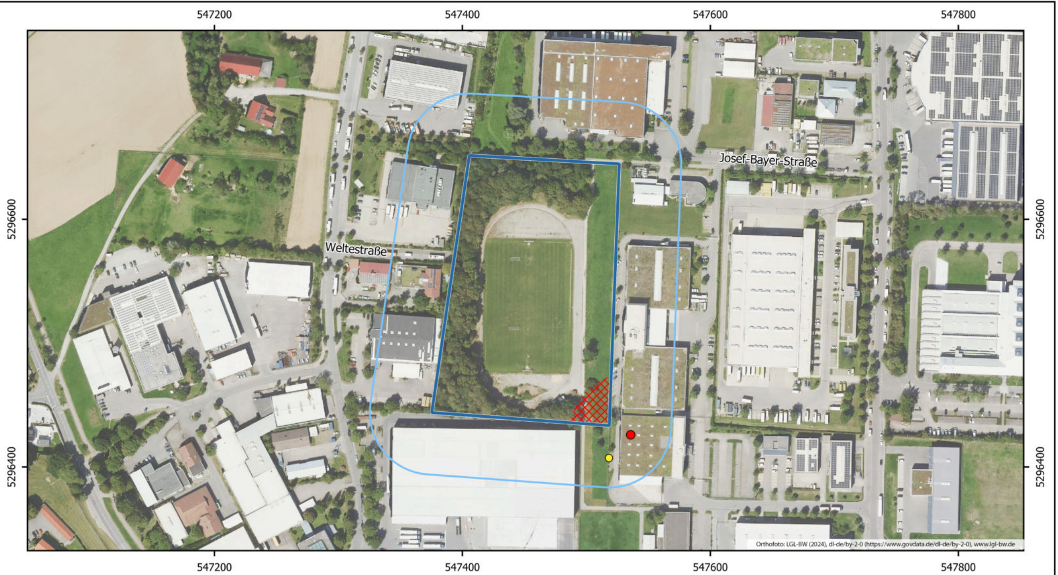
Ergebnis der Vorerkundung auf Kampfmittelbelastung. Lediglich Befunde, die innerhalb der Auswertungsfläche liegen oder darüber hinausragen, sind dargestellt.
