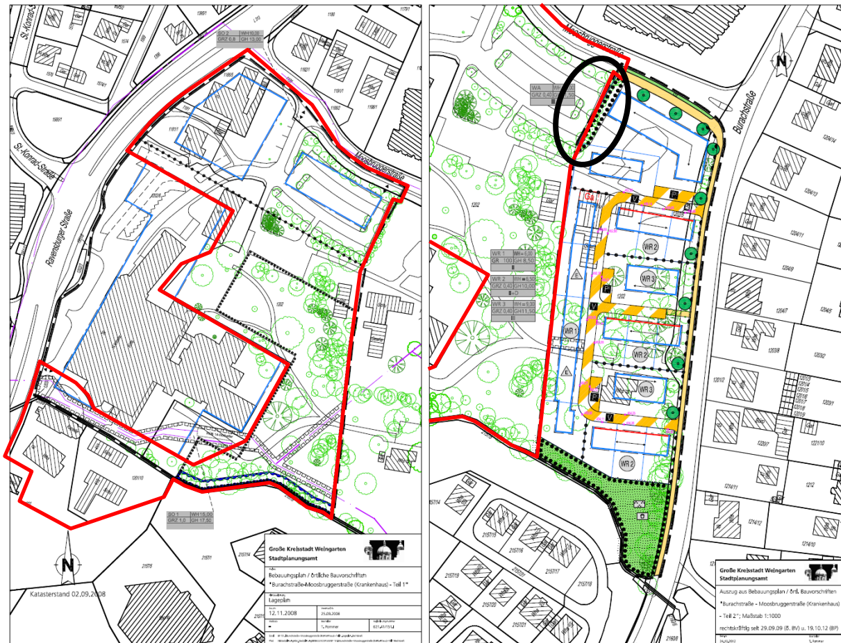
Abbildung 5: Bestehende Bebauungspläne 151.I (links) und 151.II (rechts) sowie Geltungsbereich des B-Plans 170 (rot umrandet). Schwarz umrandet der Bereich der geringfügigen Überlappung des Pflanzgebots im B-Plan 151.II mit der aktuellen Planung. Unmaßstäbliche Darstellung.
